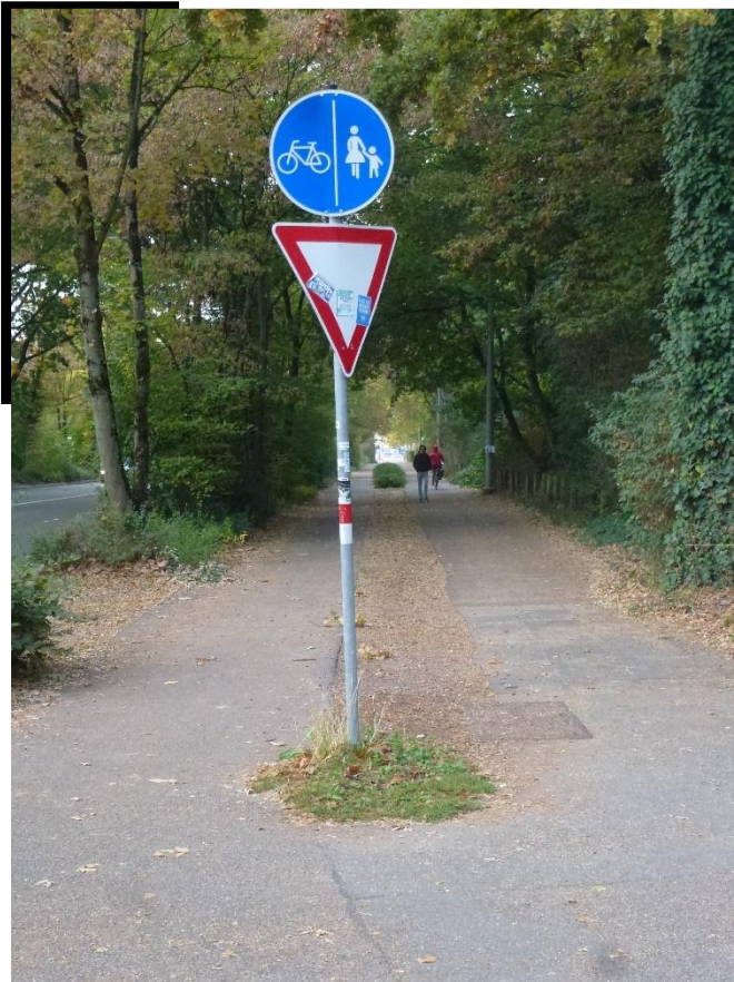
Abbildung 12: Beispiel einer unabhängigen Radwegführung in einem anbaufreien Gebiet
